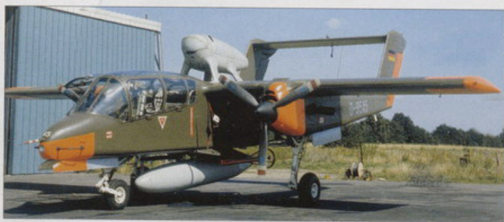
Eine der deutschen Broncos der OV-10B(Z)-Version in Lübeck-Blankensee. Sie trug ein zusätzliches J85-Triebwerk auf dem Rumpf.
